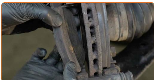
Sostituzione: pastiglie freni - DACIA Dokker Station Wagon (KE\_). AUTODOC raccomanda:
