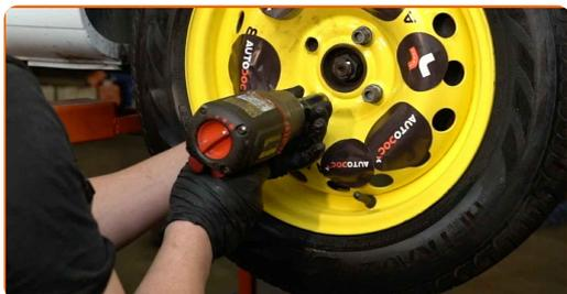
**24** Rimettere il veicolo per terra e, lavorando in ordine incrociato, serrare i bulloni di fissaggio delle ruote. Usa la chiave a bussola per dadi cerchio ruota n.17. Usa una chiave dinamometrica. Serralo fino allo coppia di torsione di 105 Nm.
