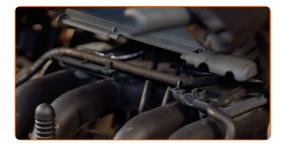
Rimuovi ilcavi connettori della candela dai loro fori. Usa delle pinze a becchi lunghi.
