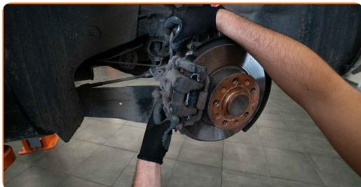
**19** Serrare il sostegno pinza freno. Usa la chiave XZN n.14. Usa una chiave dinamometrica. Serralo fino allo coppia di torsione di 90 Nm.
