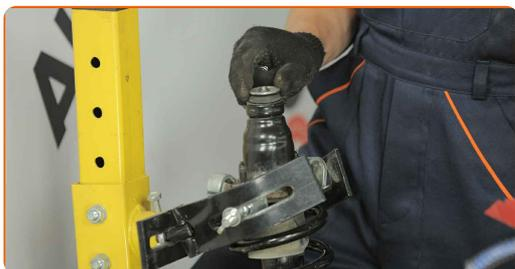
**26** Serrare la vite dell'asta pistone supporto ammortizzazione. Utilizza una chiave combinata N°17. Usa una chiave HEX N.H6. Usa una chiave dinamometrica. Serralo fino allo coppia di torsione di 29 Nm.
