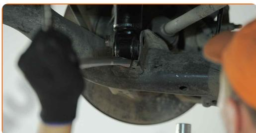
**38** Monta il bullone di fissaggio. Usa un piede di porco. Utilizza una chiave a bussola N°17. Usa una chiave a cricchetto.
