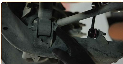
**7** Svita l'elemento di fissaggio inferiore del supporto di ammortizzazione. Utilizza una chiave a bussola N°17. Usa un giramaschi. Usa una chiave a cricchetto.
