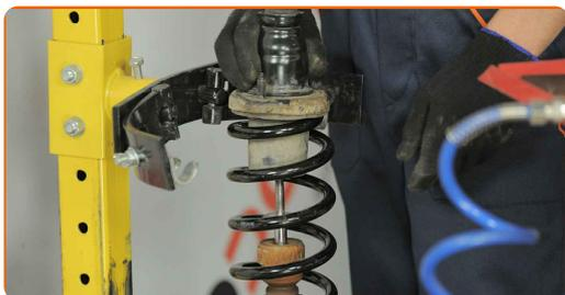
**30** Installare il supporto di ammortizzazione nell'arco passaruota.
