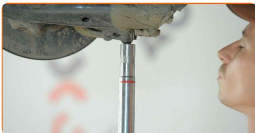
**40** Serrare il perno di fissaggio inferiore del supporto di ammortizzazione. Utilizza una chiave a bussola N°17. Usa una chiave dinamometrica. Serralo fino allo coppia di torsione di 93 Nm.
