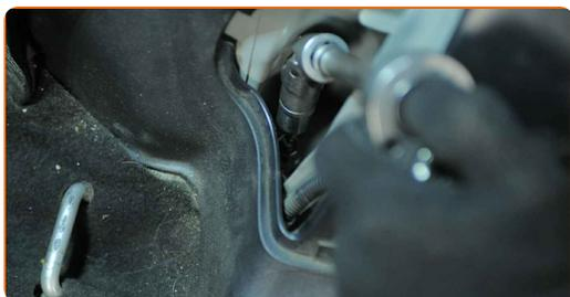
**33** Tratta con del prodotto gli elementi di fissaggio del supporto del puntone dell'ammortizzatore. Usa il grasso al rame.
