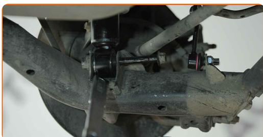
**39** Puntellare il braccio. Usa un cric idraulico per trasmissione.
