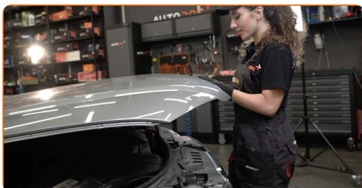
**20** Usa una copertura di protezione del parafrangente per evitare il danneggiamento della verniciatura e dei componenti in plastica dell'auto.
