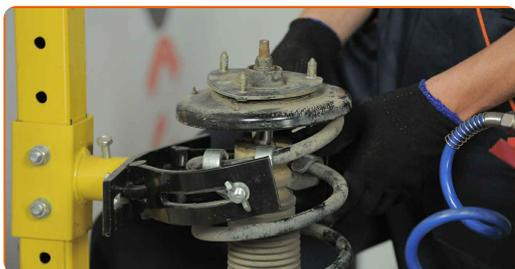
**38** Serrare la vite dell'asta pistone supporto ammortizzazione. Utilizza una chiave combinata N°17. Usa una chiave HEX N.H7. Usa una chiave dinamometrica. Serralo fino allo coppia di torsione di 44 Nm.
