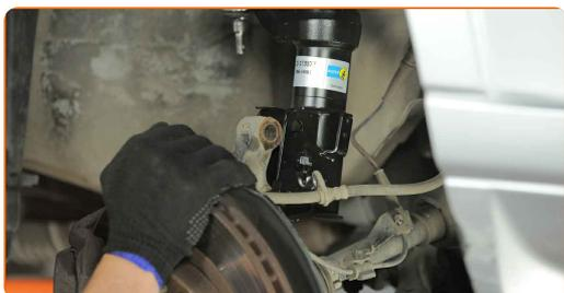
**50** Monta i bulloni di fissaggio (2 pezzi). Usa una chiave a cricchetto.
