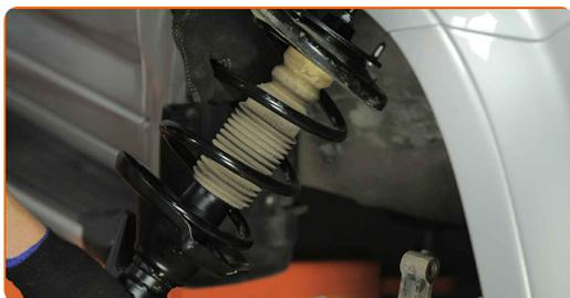
**43** Avvita l'elemento di fissaggio superiore del montante supporto ammortizzazione.
