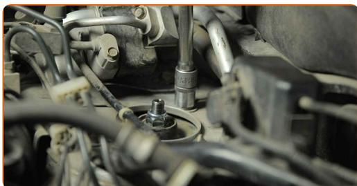
**45** Tratta con del prodotto gli elementi di fissaggio del supporto del puntone dell'ammortizzatore. Usa il grasso al rame.
