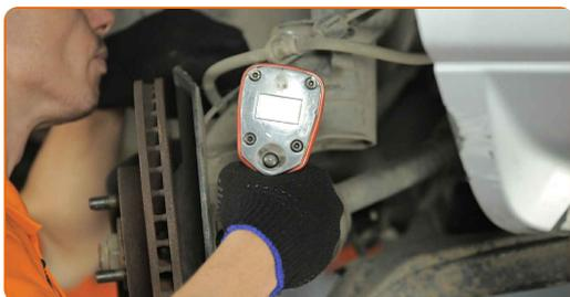
**16** Rimuovi i bulloni di fissaggio (2 pezzi).
