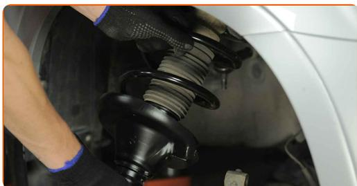
**39** Avvita l'elemento di fissaggio superiore del montante supporto ammortizzazione.
