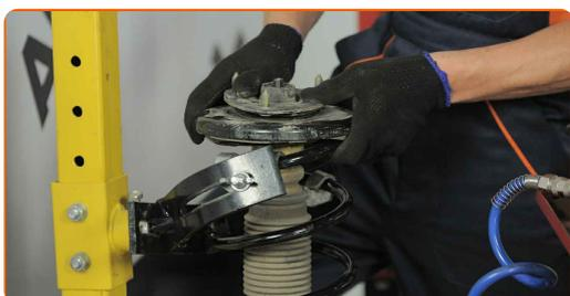
**34** Serrare la vite dell'asta pistone supporto ammortizzazione. Utilizza una chiave combinata N°19. Usa una chiave HEX N.H7. Usa una chiave dinamometrica. Serralo fino allo coppia di torsione di 44 Nm.
