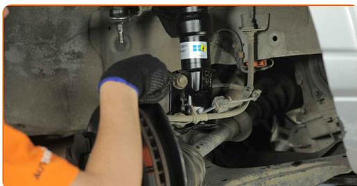
**15** Svita gli elementi di fissaggio che collegano il puntone dell'ammortizzatore al fuso a snodo. Utilizza una chiave combinata N°19. Utilizza una chiave a bussola N°22. Usa una chiave a cricchetto.
