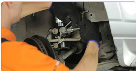
**13** Rimuovere la staffa supporto del cablaggio ABS.
