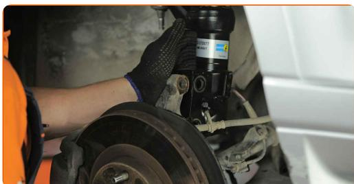
**46** Monta i bulloni di fissaggio (2 pezzi).
