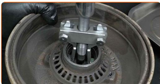
**16** Rimuovere l'anello esterno del cuscinetto della ruota dal tamburo del freno. Usare un set di montaggio/smontaggio cuscinetti e boccole.
