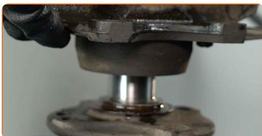
**59** Pulisci le sedi di montaggio del puntone dell'ammortizzatore. Pulisci la sede di montaggio della testina tirante dello sterzo. Pulisci le scanalature del giunto omocinetico dell'albero di trasmissione. Pulisci la sede di montaggio del giunto sferico. Usa una spazzola metallica. Usa lo spray WD-40. Usa il grasso al rame.
