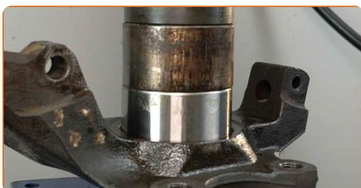
Sostituzione: cuscinetto ruota - Opel Corsa S93. Il consiglio degli esperti di AUTODOC:
