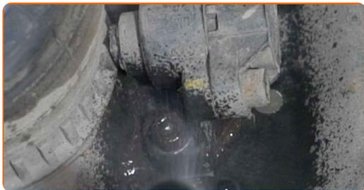
**33** Svita gli elementi di fissaggio del sensore ABS. Usa una chiave HEX N.H5. Usa una chiave a cricchetto.
