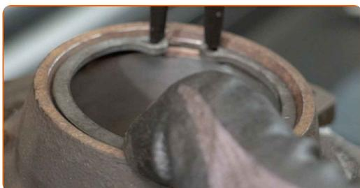
**52** Inserire a pressione il nuovo cuscinetto nel fuso a snodo. Usare un set di montaggio/smontaggio cuscinetti e boccole.
