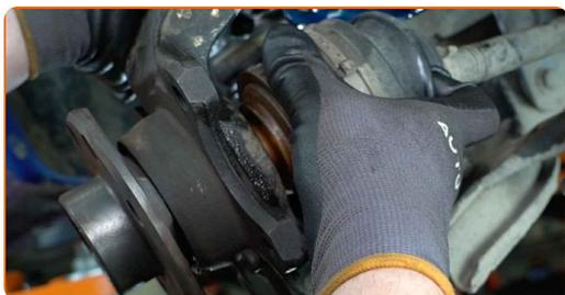
62 Installare il fuso a snodo dello sterzo.
