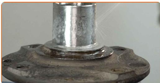
**58** Inserire a pressione un nuovo cuscinetto nel mozzo della ruota. Usare un set di montaggio/smontaggio cuscinetti e boccole.
