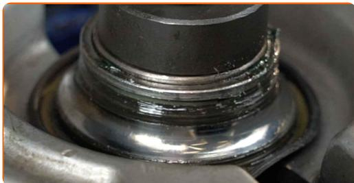
**50** Pulisci la sede di montaggio del cuscinetto del mozzo. Usa una spazzola metallica. Usa lo spray WD-40. Usa un detergente spray multiuso.
