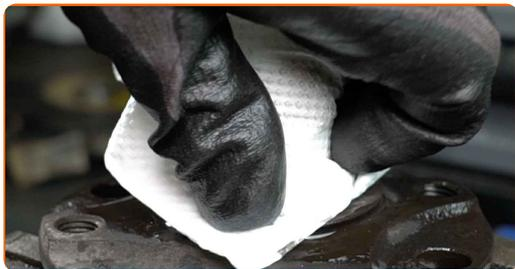
**57** Trattare la sede di montaggio del mozzo della ruota. Usa lo spray WD-40.
