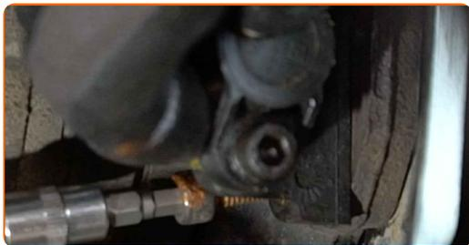
**66** Stringere l'elemento di fissaggio che collega il sensore ABS al fuso a snodo. Usa una chiave HEX N.H5. Usa una chiave dinamometrica. Serralo fino allo coppia di torsione di 8 Nm.
