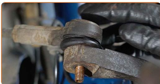
**68** Avvita il dado di serraggio che collega le testine tiranti dello sterzo al fuso a snodo. Utilizza una chiave a bussola N°17. Usa una chiave a cricchetto.
