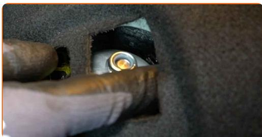
**26** Stringere l'elemento di fissaggio inferiore dell'ammortizzatore. Utilizza una chiave a bussola N°14. Usa una chiave dinamometrica. Serralo fino allo coppia di torsione di 54 Nm.
