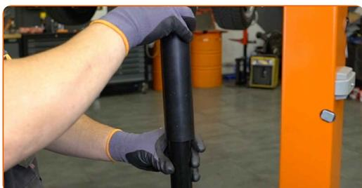
**21** Posizionare l'ammortizzatore nel passaruota e fissarlo.
