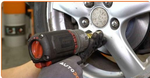
**33** Rimettere il veicolo per terra e, lavorando in ordine incrociato, serrare i bulloni di fissaggio delle ruote. Usa la chiave a bussola per dadi cerchio ruota n.19. Usa una chiave dinamometrica. Serralo fino allo coppia di torsione di 108 Nm.
