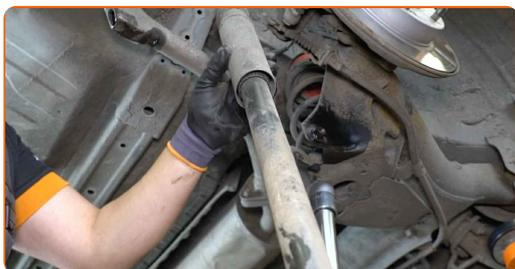
**18** Pulisci le sedi di montaggio dell'ammortizzatore. Usa una spazzola metallica.
