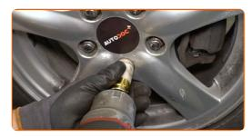
Rimettere il veicolo per terra e, lavorando in ordine incrociato, serrare i bulloni di fissaggio delle ruote. Usa la chiave a bussola per dadi cerchio ruota n.19. Usa una chiave dinamometrica. Serralo fino allo coppia di torsione di 108 Nm.
