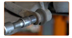
Rimuovere il collegamento dello stabilizzatore.
