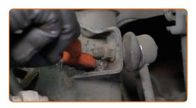
Svita gli elementi di fissaggio che collegano il tirante della barra stabilizzatrice al puntone dell'ammortizzatore. Utilizza una chiave a bussola N°14. Usa una chiave a cricchetto.
