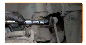
Svita gli elementi di fissaggio che collegano il tirante della barra stabilizzatrice alla barra. Utilizza una chiave a bussola N°14. Usa una chiave a cricchetto.
