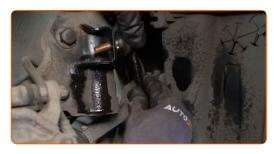
Serra gli elementi di fissaggio che collegano il tirante della barra stabilizzatrice al puntone dell'ammortizzatore.
