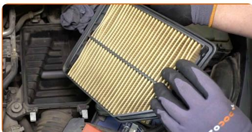
**7** Pulisci il coperchio del filtro dell'aria e l'alloggiamento.
