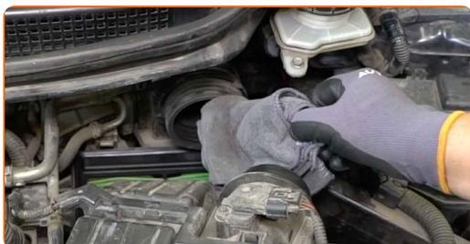
**10** Montare il coperchio del filtro dell'aria. Fissarlo.
