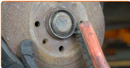
**7** Svitare gli elementi di fissaggio del tamburo del freno. Usa la chiave Torx T 30. Usa un cacciavite a percussione.
