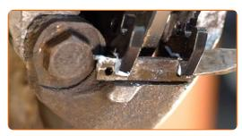
Installa il perno di fissaggio della pastiglia del freno.
