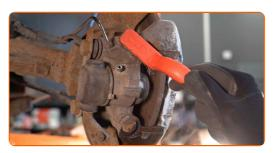
Svitare l'attacco della pinza freno. Utilizza una chiave a bussola N°19. Usa una chiave a cricchetto.
