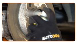
Svitare l'attacco del disco freno. Usa la chiave Torx T 30. Usa un cacciavite a percussione.
