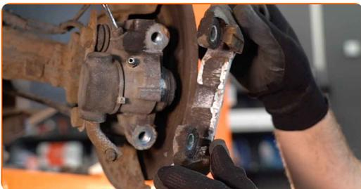
Sostituzione: dischi freni - CITROËN Xsara Van / Hatchback (N3\_). Gli esperti di AUTODOC raccomandano:
