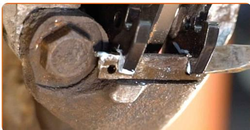
**26** Installa il perno di fissaggio della pastiglia del freno.
