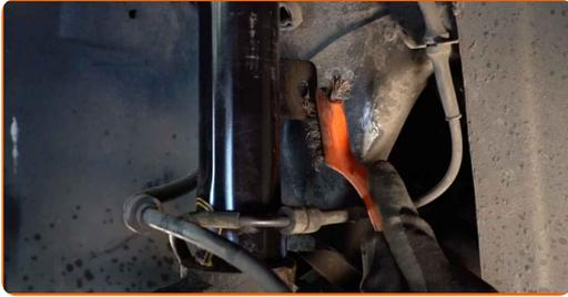
**11** Installare una nuova barra, serrarne gli elementi di montaggio.
