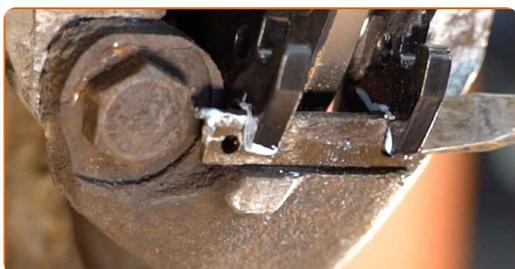
**15** Installa il perno di fissaggio della pastiglia del freno.
