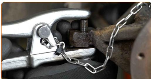
**32** Puntellare il fuso a snodo. Usa un cric idraulico per trasmissione.
