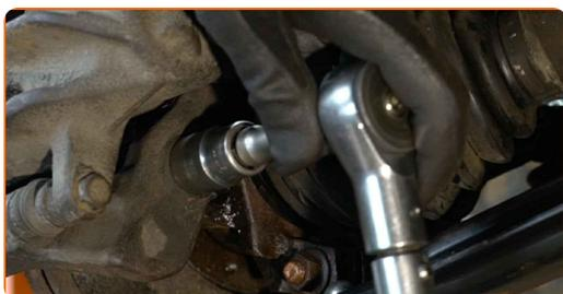
**79** Installare il supporto del tubo del freno.
