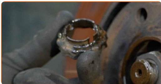
**10** Allenta l'elemento di fissaggio dell'albero di trasmissione. Utilizza una chiave a bussola N°36. Usa un giramaschi.
