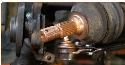
**60** Installare il fuso a snodo dello sterzo sull'assale CV.
