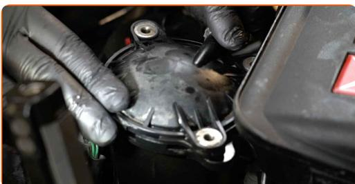
**11** Stringere gli elementi di fissaggio del coperchio di alloggiamento del filtro carburante. Usa una chiave HEX N.H4. Usa una chiave dinamometrica. Serralo fino allo coppia di torsione di 9 Nm.
