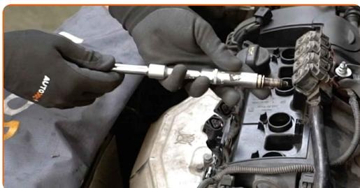
**10** Applica uno strato sottile dello speciale lubrificante antigrippaggio per alte temperature alle filettature delle candele nuove.
