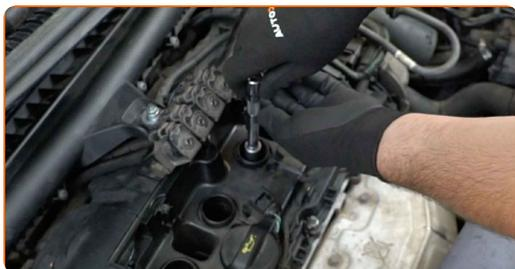
**12** Avvitare le nuove candele e serrarle. Usa la chiave a bussola per candele numero 14. Usa una chiave dinamometrica. Serralo fino allo coppia di torsione di 25 Nm.
