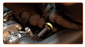
Svita il morsetto che serra l'alloggiamento del filtro aria del motore al corpo della farfalla. Utilizza una chiave a bussola N°7.
