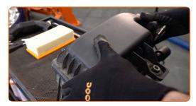
Avvita le viti di serraggio sul coperchio del filtro dell'aria. Usa un cacciavite Phillips.
