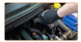
Stringi il morsetto che serra l'alloggiamento del filtro aria del motore al corpo della farfalla. Utilizza una chiave a bussola N°7.
