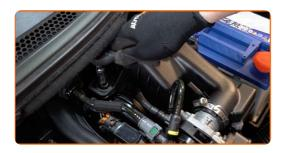
6 Scollega il tubo di aspirazione dell'aria dall'alloggiamento del filtro dell'aria.
