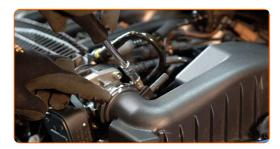
Connetti il tubo flessibile del sistema di ventilazione del basamento al condotto dell'aria.
