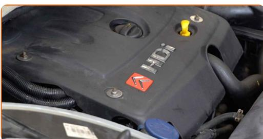
**24** Controllare il livello dell'olio 5 minuti dopo l'arresto del motore, utilizzando un'asta, e aggiungere olio, se necessario.
