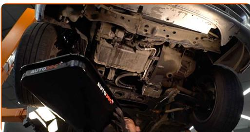
**8** Pulisci la zona del foro di drenaggio della coppa dell'olio. Usa una spazzola metallica. Usa un detergente spray multiuso.
