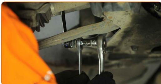
**13** Serra gli elementi di fissaggio che collegano il tirante della barra stabilizzatrice al puntone dell'ammortizzatore. Utilizza una chiave combinata N°19. Usa una chiave HEX N.H6. Usa una chiave dinamometrica. Serralo fino allo coppia di torsione di 65 Nm.
