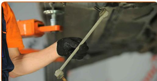
Sostituzione: bielle barra stabilizzatrice - CITROËN C5 II (RC\_). Gli esperti di AUTODOC raccomandano:
