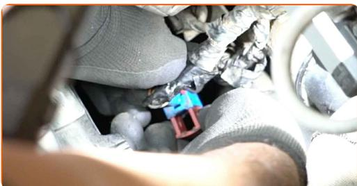
**4** Pulire l'elemento di fissaggio del sensore di ossigeno. Usa una spazzola metallica. Usa lo spray WD-40.
