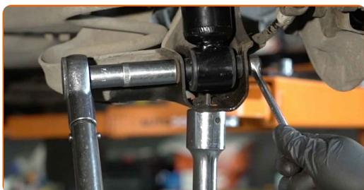
**27** Rimuovi il supporto da sotto la trave dell'asse posteriore.
