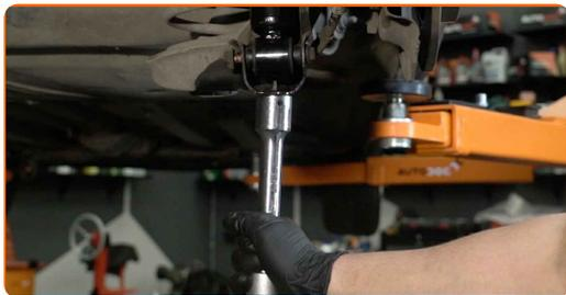
**26** Stringi l'elemento di fissaggio inferiore dell'ammortizzatore. Utilizza una chiave combinata N°13. Utilizza una chiave a bussola N°15. Usa una chiave dinamometrica. Serralo fino allo coppia di torsione di 57 Nm.
