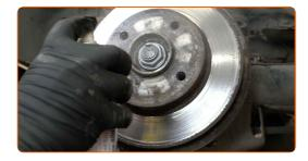
Svitare il supporto di fissaggio del mozzo della ruota. Utilizza una chiave a bussola N°32. Usa un giramaschi.
