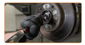
Pulisci l'elemento di fissaggio del mozzo della ruota. Usa lo spray WD-40.
