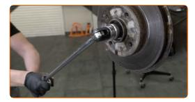
Rimuovi il disco freno assemblato con il cuscinetto del mozzo della ruota. Utilizza un estrattore mozzo ruota con martello scorrevole.
