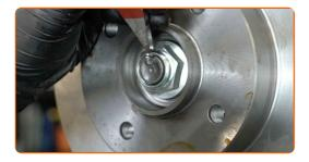
Installare il cappuccio di protezione del cuscinetto del mozzo. Usa un martello di gomma.
