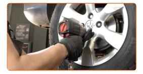
Rimettere il veicolo per terra e, lavorando in ordine incrociato, serrare i bulloni di fissaggio delle ruote. Usa la chiave a bussola per dadi cerchio ruota n.17. Usa una chiave dinamometrica. Serralo fino allo coppia di torsione di 100 Nm.
