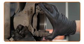
Serrare il sostegno pinza freno. Usa la chiave Torx T 50. Usa una chiave dinamometrica. Serralo fino allo coppia di torsione di 53 Nm.
