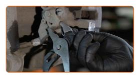
Svitare l'attacco della pinza freno. Utilizza una chiave combinata N°15. Utilizza una chiave a bussola N°13. Usa una chiave a cricchetto.
