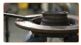
24 Installare l'anello sensore ABS.
