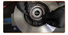
Pulire l'asse del mozzo a snodo. Usa una spazzola metallica. Usa un detergente spray multiuso.
