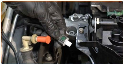
**117** Collegare i tubi del carburante al filtro del carburante e bloccare i ganci di fissaggio.
