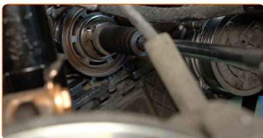
**87** Ruotare l'ingranaggio dell'albero a gomiti. Utilizza una chiave a bussola N°22. Usa una chiave a cricchetto.
