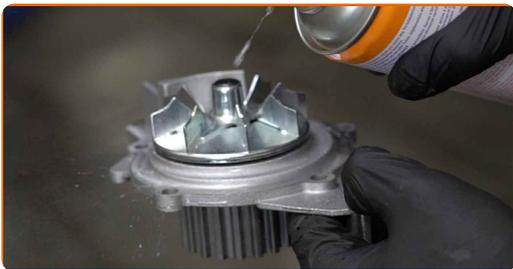
**67** Installare la guarnizione della pompa dell'acqua.
