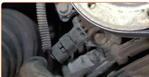
**30** Separare il cablaggio del sensore di posizione dell'albero a gomiti. Usa uno strumento per estrazione clip.
