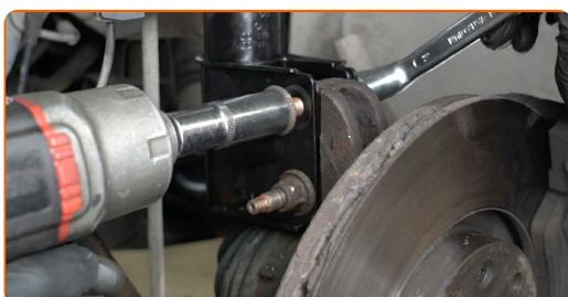
**35** Serra gli elementi di fissaggio inferiori che collegano l'ammortizzatore al fuso a snodo. Utilizza una chiave combinata N°18. Utilizza una chiave a bussola N°18. Usa una chiave dinamometrica. Serralo fino allo coppia di torsione di 90 Nm.
