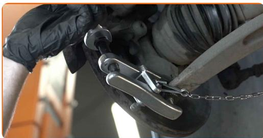
**13** Puntellare il fuso a snodo. Usa un cric idraulico per trasmissione.
