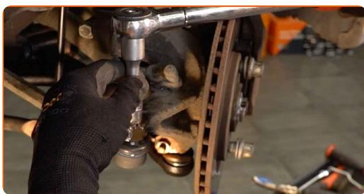
**18** Serrare il controdado del gambo. Utilizza una chiave combinata N°19 (2 pezzi). Usa una chiave dinamometrica. Serralo fino alla coppia di torsione di 62 Nm.
