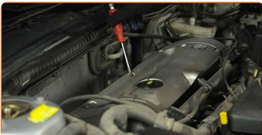
**4** Rimuovere la copertura del motore. Usa un giravite piatto.
