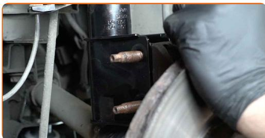
**34** Avvita l'elemento di fissaggio che collega il puntone dell'ammortizzatore al fuso a snodo. Utilizza una chiave combinata N°18. Utilizza una chiave a bussola N°18. Usa una chiave a cricchetto.
