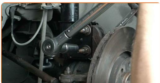
**36** Serra il dado dell'albero di trasmissione. Utilizza una chiave a bussola N°36. Usa una chiave dinamometrica. Serralo fino allo coppia di torsione di 280 Nm.
