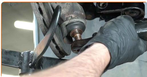
**31** Rimuovi il supporto da sotto il fuso a snodo.
