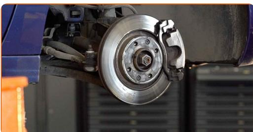
**13** Scollegare il cablaggio e il tubo flessibile freno dalla staffa del supporto di ammortizzazione.
