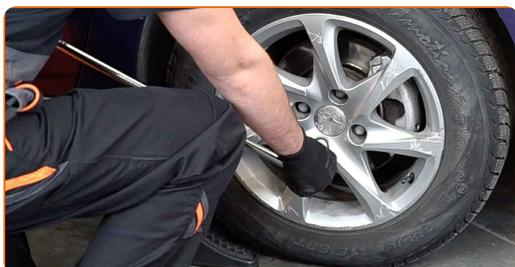
**9** Allenta l'elemento di fissaggio dell'albero di trasmissione. Utilizza una chiave a bussola N°32. Usa un giramaschi.
