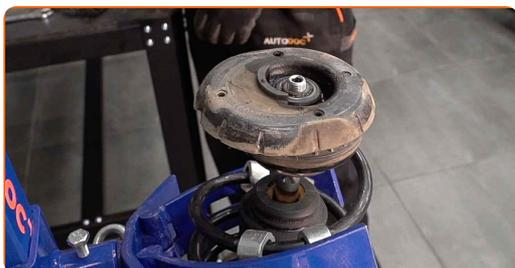
**43** Serrare la vite dell'asta pistone supporto ammortizzazione. Utilizza una chiave combinata N°19. Usa una chiave HEX N.H7. Usa una chiave dinamometrica. Serralo fino allo coppia di torsione di 60 Nm.
