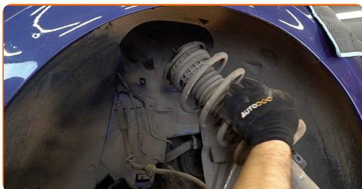
**34** Montare il supporto di ammortizzazione sul dispositivo speciale per la compressione delle molle.
