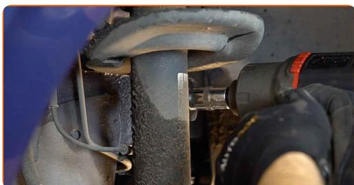
**16** Pulisci gli elementi di fissaggio che collegano il puntone dell'ammortizzatore al fuso a snodo. Usa una spazzola metallica. Usa lo spray WD-40.
