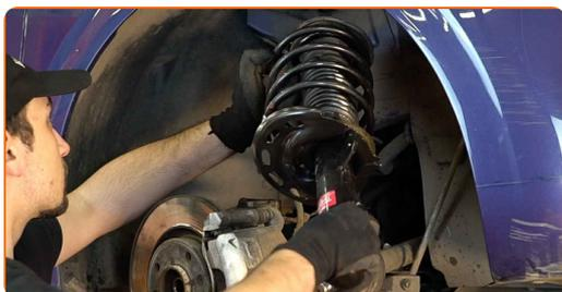
**47** Avvita l'elemento di fissaggio superiore del montante supporto ammortizzazione. Non lo serrare.
