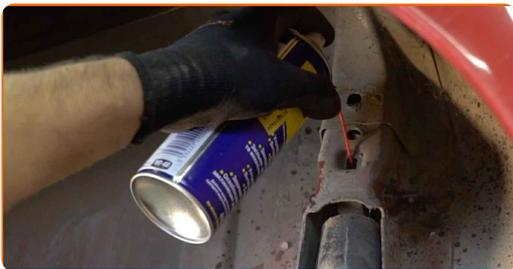
**13** Svita l'elemento di fissaggio superiore dell'ammortizzatore. Utilizza una chiave a bussola N°16. Usa un giramaschi.
