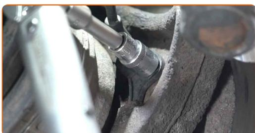
**66** Stringi gli elementi di fissaggio del giunto sferico. Utilizza una chiave a bussola N°21. Usa una chiave dinamometrica. Serralo fino allo coppia di torsione di 50 Nm.
