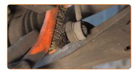
Svita gli elementi di fissaggio che collegano il tirante della barra stabilizzatrice alla barra. Utilizza una chiave combinata N°17. Usa la chiave Torx T 30. Usa una chiave a cricchetto.
