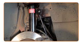
Serra gli elementi di fissaggio che collegano il tirante della barra stabilizzatrice alla barra. Utilizza una chiave a bussola N°17. Usa una chiave dinamometrica. Serralo fino allo coppia di torsione di 35 Nm.
