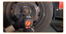
Rimettere il veicolo per terra e, lavorando in ordine incrociato, serrare i bulloni di fissaggio delle ruote. Usa la chiave a bussola per dadi cerchio ruota n.17. Usa una chiave dinamometrica. Serralo fino allo coppia di torsione di 90 Nm.
