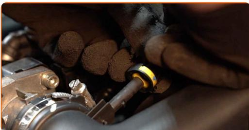
**4** Svita il morsetto che serra l'alloggiamento del filtro aria del motore al corpo della farfalla. Utilizza una chiave a bussola N°7.
