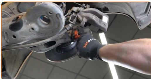
**29** Installare il sostegno pinza freno.
