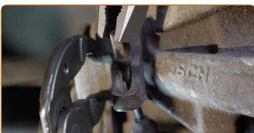
**9** Pulisci gli elementi di fissaggio della pinza freno. Usa una spazzola metallica. Usa un detergente spray multiuso.
