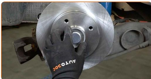
**28** Pulisci le sedi di montaggio della pinza e la sua staffa. Usa una spazzola metallica. Usa lo spray WD-40.
