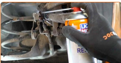
**8** Sgancia il cavo del freno di stazionamento. Usa le pinze per pompa ad acqua. Usa delle pinze. Usa un piede di porco.
