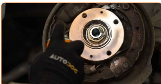
**18** Installare il cappuccio di protezione del cuscinetto del mozzo. Usa un martello di gomma.
