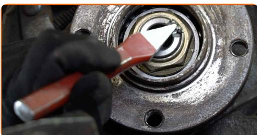
**11** Svitare il supporto di fissaggio del mozzo della ruota. Utilizza una chiave a bussola N°34. Usa un giramaschi.
