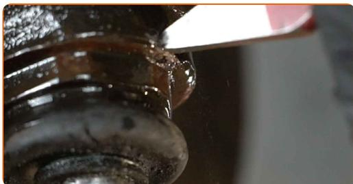
**19** Svitare il perno che fissa il giunto sferico al fuso a snodo. Utilizza una chiave a bussola N°41. Usa una chiave a cricchetto.
