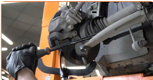
**15** Rimuovi il supporto da sotto il fuso a snodo.
