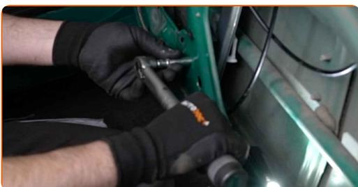
**22** Abbassare il vetro del finestrino e installarlo nella sua sede di montaggio nel meccanismo alzacristalli.
