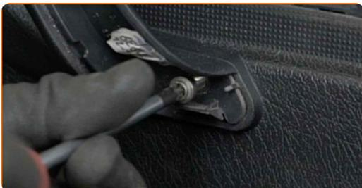
**30** Installare il telaio della maniglia della portiera.
