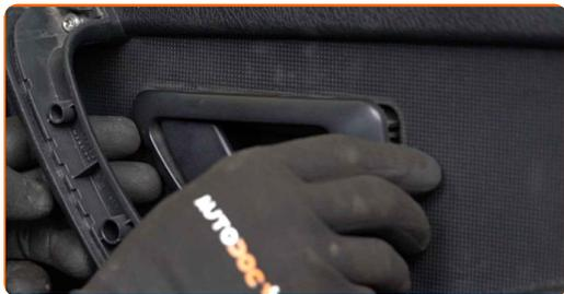
**31** Avvitare gli elementi di fissaggio inferiori della scheda portiera. Usa la chiave Torx T20.
