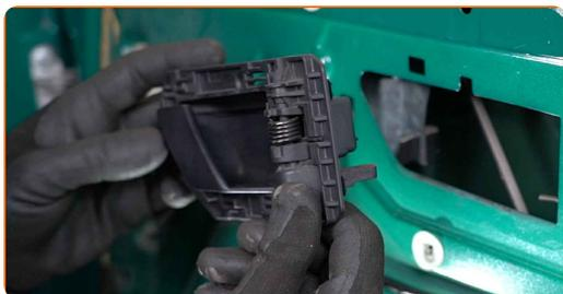
**15** Staccare gli elementi di fissaggio del vetro. Usa un attrezzo di plastica per la rimozione finiture auto.
