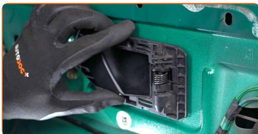
**13** Abbassare il vetro in modo da poter vedere gli elementi di fissaggio che collegano il vetro al meccanismo di regolazione del finestrino.
