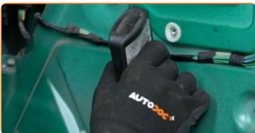
**21** Stringere gli elementi di fissaggio del gruppo regolatore dell'alzacristalli. Utilizza una chiave a bussola N°10. Usa una chiave dinamometrica. Serralo fino allo coppia di torsione di 12 Nm.
