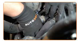
Fissare il morsetto del tubo di raffreddamento. Utilizza una chiave a bussola N°7. Usa una chiave a cricchetto.
