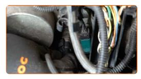
Installare il coperchio del cablaggio del motore. Assicurati di sentire un clic indicante che si trova installato saldamente.
