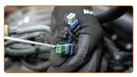
Collegare i connettori del cablaggio del motore.
