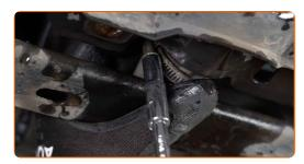
Pulire il tubo del liquido refrigerante. Usa un detergente spray multiuso.
