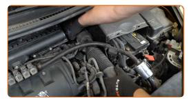
Avvita l'elemento di fissaggio del tubo della presa d'aria. Utilizza una chiave a bussola N°10. Usa una chiave a cricchetto.
