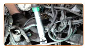
Stringere il perno di sostegno dell'alloggiamento del termostato. Utilizza una chiave a bussola N°E5. Usa una chiave dinamometrica. Serralo fino allo coppia di torsione di 11 Nm.
