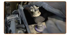
Premere le clip di fissaggio della batteria per sbloccarle.
