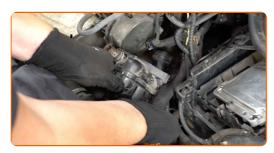
Pulire la sede di montaggio dell'alloggiamento del termostato. Usa un raschietto per sigillante. Usa un detergente spray multiuso.
