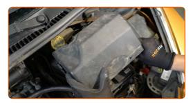
Svita gli elementi di fissaggio dei terminali della batteria dell'auto. Utilizza una chiave combinata N°8.
