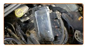
Rimuovere il coperchio del cablaggio del motore.
