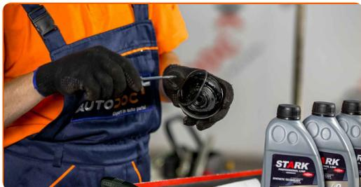
**11** Lubrifica la guarnizione di gomma del filtro nuovo con una piccola quantità di olio fresco.
