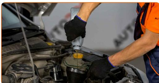
Sostituzione: olio motore e filtro - Opel Corsa C. AUTODOC raccomanda:
