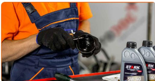
**9** Pulisci il tappo dell'alloggiamento del filtro dell'olio. Usa un detergente spray multiuso.
