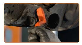
Collocare l'ammortizzatore nell'arco passaruota e fissalo.
