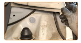
Rimuovi la cuffia del supporto dall'elemento di fissaggio superiore dell'ammortizzatore.
