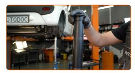
Tratta con del prodotto le sedi di montaggio dell'ammortizzatore. Usa una spazzola metallica. Usa lo spray WD-40.
