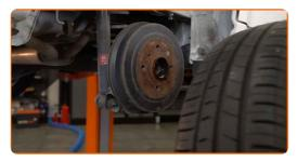
Pulisci gli elementi di fissaggio dell'ammortizzatore. Usa una spazzola metallica. Usa lo spray WD-40.
