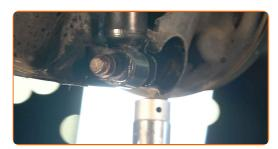
Stringi l'elemento di fissaggio inferiore dell'ammortizzatore. Utilizza una chiave a bussola N°14. Usa una chiave dinamometrica. Serralo fino allo coppia di torsione di 48 Nm.
