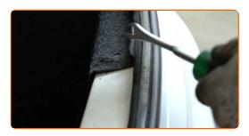
Svita l'elemento di fissaggio del rivestimento laterale del cofano. Usa un cacciavite Phillips.
