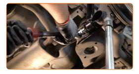
Avvita gli elementi di fissaggio superiori dell'ammortizzatore.
