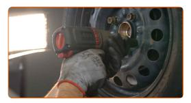
Rimettere il veicolo per terra e, lavorando in ordine incrociato, serrare i bulloni di fissaggio delle ruote. Usa la chiave a bussola per dadi cerchio ruota n.17. Usa una chiave dinamometrica. Serralo fino allo coppia di torsione di 100 Nm.
