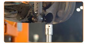
Avvita l'elemento di fissaggio inferiore dell'ammortizzatore. Utilizza una chiave a bussola N°14.
