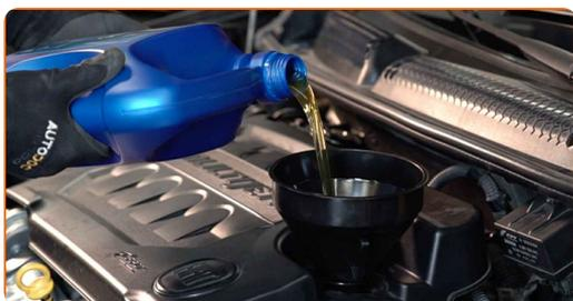
**Sostituzione: olio motore e filtro - Fiat Bravo 198. AUTODOC raccomanda:**
