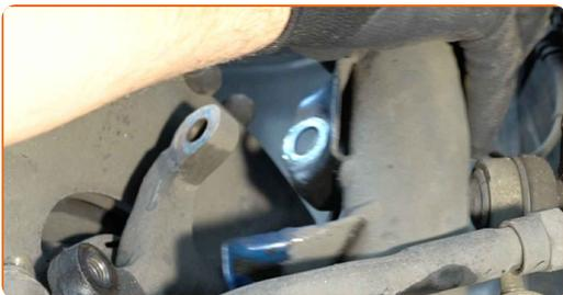
**17** Svitare gli elementi di fissaggio superiori del puntone dell'ammortizzatore.
