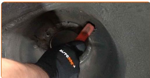
**33** Installare il supporto di ammortizzazione nell'arco passaruota.
