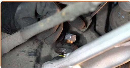
**32** Rimuovi il supporto da sotto il fuso a snodo.
