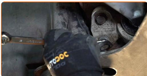
**31** Inserire il supporto sferico nel fuso a snodo e fissarlo tramite un nuovo dado.
