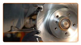
Serrare il sostegno pinza freno. Utilizza una chiave a bussola N°16. Usa una chiave dinamometrica. Serralo fino allo coppia di torsione di 110 Nm.
