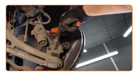
Installare il sostegno pinza freno.
