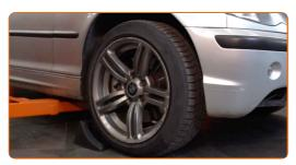
Allentare i bulloni di fissaggio della ruota. Usa la chiave a bussola per dadi cerchio ruota n.17.
