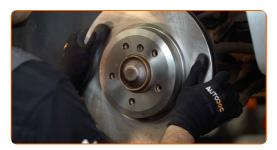
Serrare l'attacco del disco freno. Usa la chiave Torx T30. Usa una chiave dinamometrica. Serralo fino allo coppia di torsione di 16 Nm.
