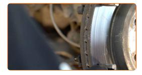
Pulisci la superficie del disco freno. Usa una spazzola metallica. Usa lo spray WD-40.
