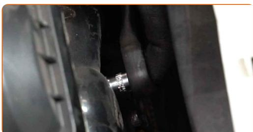
**16** Pulire gli elementi di fissaggio dell'alloggiamento del termostato. Usa un detergente spray multiuso.
