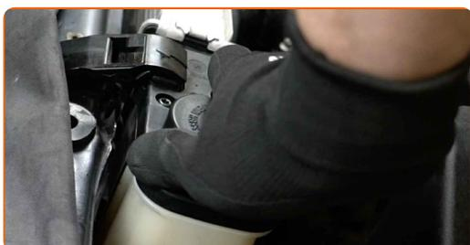
**51** Far funzionare il motore per qualche minuto. Tale operazione deve essere effettuata al fine di rimuovere l'aria residua dal sistema di raffreddamento e verificare che i componenti funzionino correttamente.
