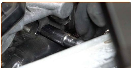
**15** Svitare gli elementi di fissaggio dell'alloggiamento del termostato. Utilizza una chiave a bussola N°10. Usa una chiave a cricchetto.
