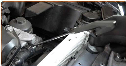
**17** Svitare gli elementi di fissaggio dell'alloggiamento del termostato. Utilizza una chiave a bussola N°10. Usa una chiave a cricchetto.
