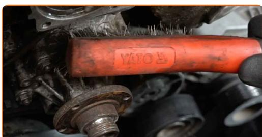
**25** Svitare i dispositivi di fissaggio della pompa dell'acqua. Utilizza una chiave a bussola N°10. Usa una chiave a cricchetto.
