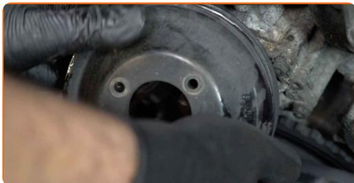
**24** Pulire la sede di montaggio della pompa dell'acqua. Usa una spazzola metallica. Usa un detergente spray multiuso.
