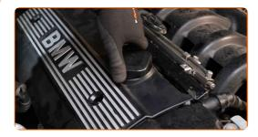
Avvita gli elementi di fissaggio del coperchio del motore. Utilizza una chiave a bussola N°10. Usa una chiave a cricchetto.
