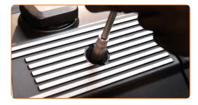
Montare il coperchio motore e fissarlo.
