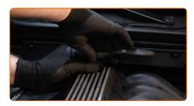
Rimuovere la copertura del motore.
