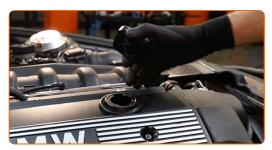
Rimuovere la copertura del motore.
