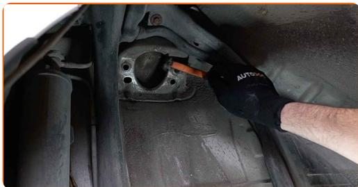
**28** Collocare l'ammortizzatore nell'arco passaruota e fissalo.
