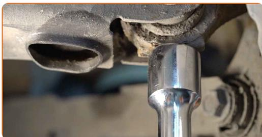
**42** Collega la parte inferiore dell'ammortizzatore.
