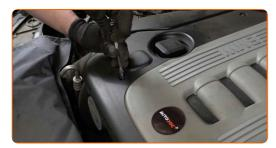
Rimuovere la copertura del motore.
