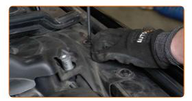
Rimuovi i coperchi di protezione dell'elemento di fissaggio del supporto di ammortizzazione.
