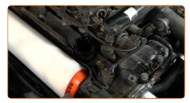
Montare il coperchio del filtro d'aria. Fissarlo.
