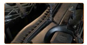
Rimettere a posto la sezione posteriore del coperchio motore.
