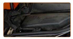
Svitare gli elementi di fissaggio della parte inferiore dell'involucro del filtro abitacolo. Usa la chiave Torx T 25. Usa una chiave a cricchetto.
