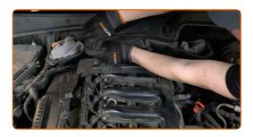
Montare il coperchio motore e fissarlo.
