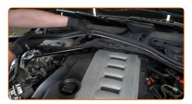
Svitare gli elementi di fissaggio della parte inferiore dell'involucro del filtro abitacolo. Utilizza una chiave a bussola N°13. Usa una chiave a cricchetto.
