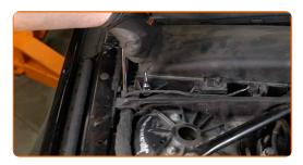
Reinstallare il coperchio della scatola filtro abitacolo. Assicurati di sentire un clic indicante che si trova installato saldamente.
