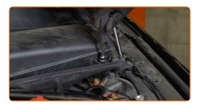
Avvitare gli elementi di fissaggio della parte inferiore dell'involucro del filtro abitacolo. Usa la chiave Torx T 25. Usa una chiave a cricchetto.
