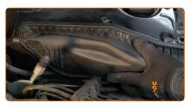
Avvita l'elemento di fissaggio del tubo della presa d'aria. Usa una chiave HEX N.H5. Usa una chiave a cricchetto.
