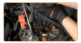
Installare i coperchi di protezione dell'elemento di fissaggio del supporto di ammortizzazione.
